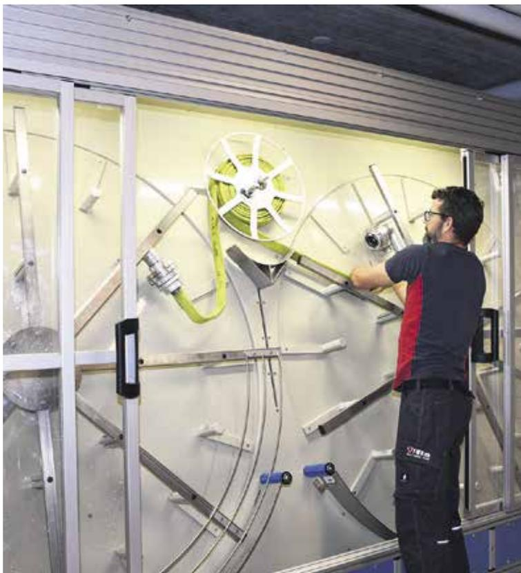
Vorführung der neuen Schlauch-Wasch- und Prüfanlage.
